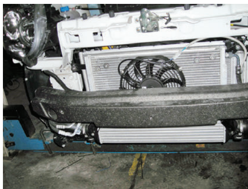
Widok skraplacza jednostki FRIGIday zamontowanej w komorze silnika
